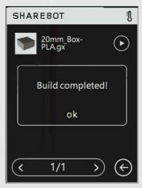
L'estrusore si riscalderà automaticamente e quando raggiungerà la temperatura esatta, la stampante inizierà a costruire il modello. Quando la stampa sarà terminata sentirete un suono e potrete vedere sul monitor una notifica di fine stampa.
